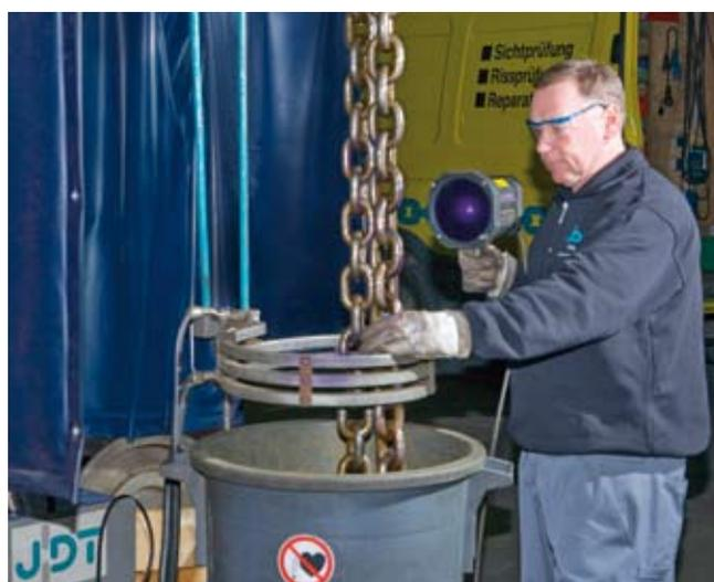
Magnetische Rissprüfung – fluxen.
