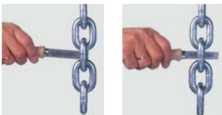
Einfacher und schneller geht es mit den von JDT entwickelten Grenzmesslehren. Diese gibt es für Ketten von 6-28 mm.
