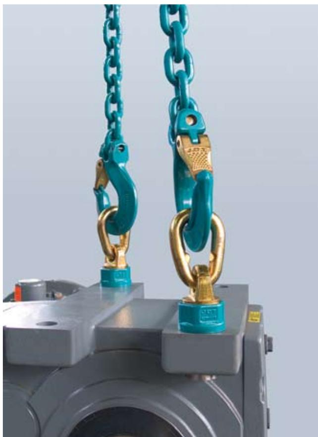
JDT Gabelkopfhaken sind so konstruiert, dass bei einer Überlastung der Haken nicht schlagartig bricht. Das Hakenmaul öffnet sich sichtbar und lässt die Last langsam aus dem Haken gleiten.
